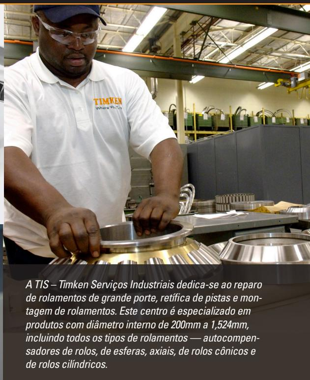
A TIS – Timken Serviços Industriais dedica-se ao reparo de rolamentos de grande porte, retífica de pistas e montagem de rolamentos. Este centro é especializado em produtos com diâmetro interno de 200mm a 1,524mm, incluindo todos os tipos de rolamentos — autocompensadores de rolos, de esferas, axiais, de rolos cônicos e de rolos cilíndricos.
